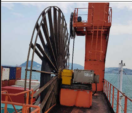
부산북항 고박장치 미설치 사진 (케이블릴 접근 난이)
