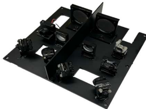
그림. 유출 오일 및 적조 동시 측정 소형 하이브리드 광센서의 광학계 제작
