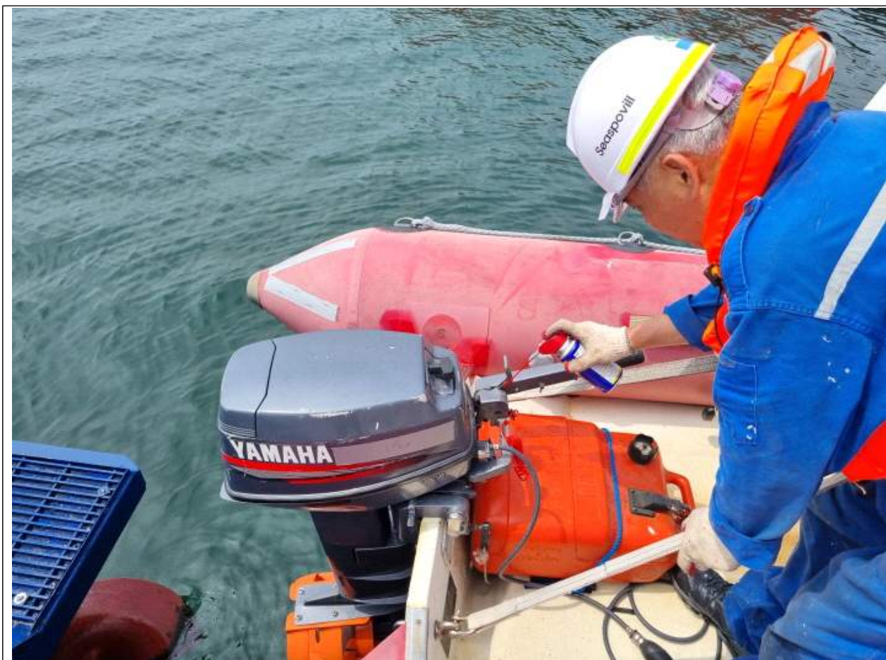
△구명장치(구조정) 고정장치 등 설비관리실태 점검 및 레버 고착(즉시조치)
