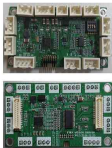
<해수 미량금속 전처리 장비에 사용된 모터드라이버(좌) 및 노드 컨트롤러 시스템(우)>
