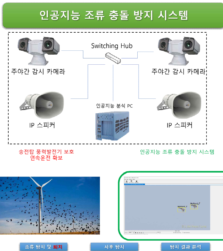
그림 1 인공지능 조류 충돌 방지 시스템 개요
