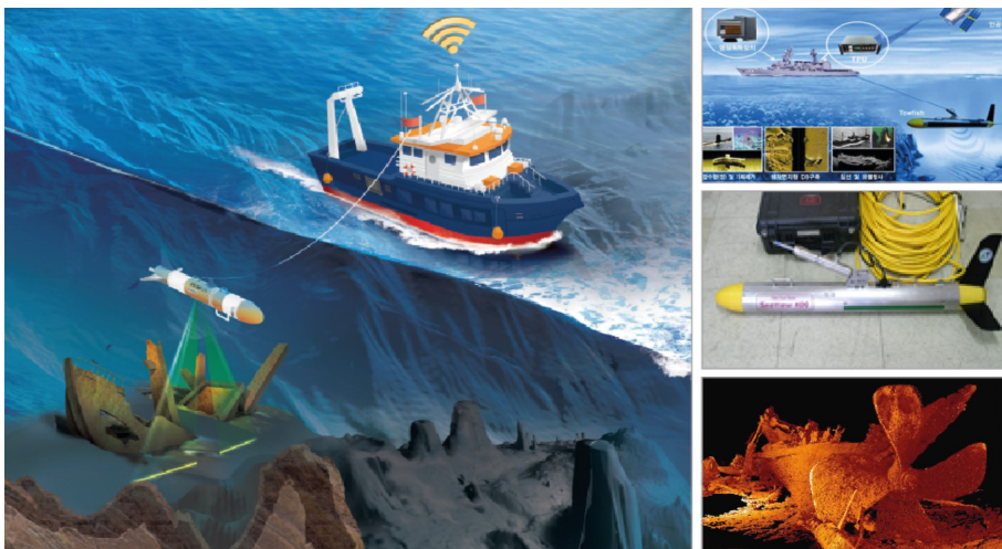
[ 그림 26 ] 해저면 영상조사 운용모식도 및 방법
