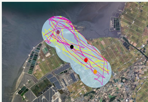
[ 그림 83 ] 무선추적장치를 이용하여 해안풍력발전기 4기 주변에서 추적된 조류의 이동 양상의 사례
