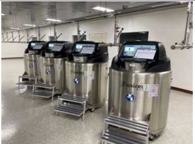
△ 해양바이오 원천소재 보존을 위한 초저온 냉동 시스템
