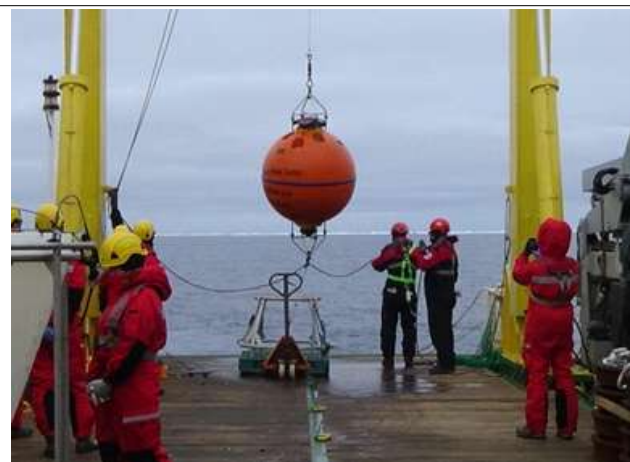
바다의 변화 관찰을 위한 수중 장기계류관측시스템 설치
