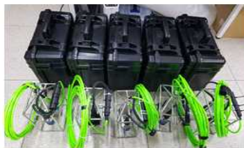
클로로필 센서 2,000cells/mL = 500µg/L
